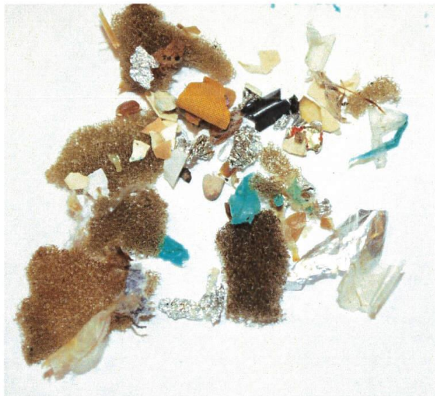
Figur 3 Eksempler på frasorterede emner. Der ses grøn plastfolie fra poserester, mindre plastemner, rester af skum, og rester af alufolie. Emnerne er forstørrede.
