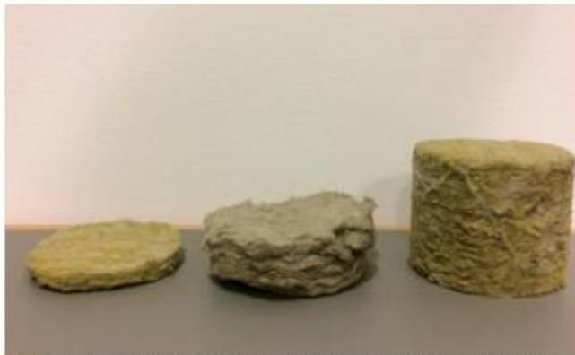
De tre referencematerialer. Fra venstre mod højre: 15 mm kompakt mineraluld, 40 mm blødt isoleringsmateriale, 80 mm kompakt mineraluld.
