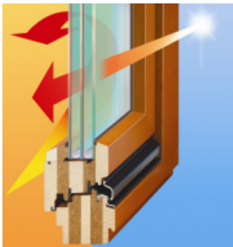
Principskitse af energivindue med varm kant med indsatte korkstykker. Et dansk vindue med U-værdi på 0,8 (rudens U-værdi er 0,6) fås f.eks. hos Vrognum A/S.
