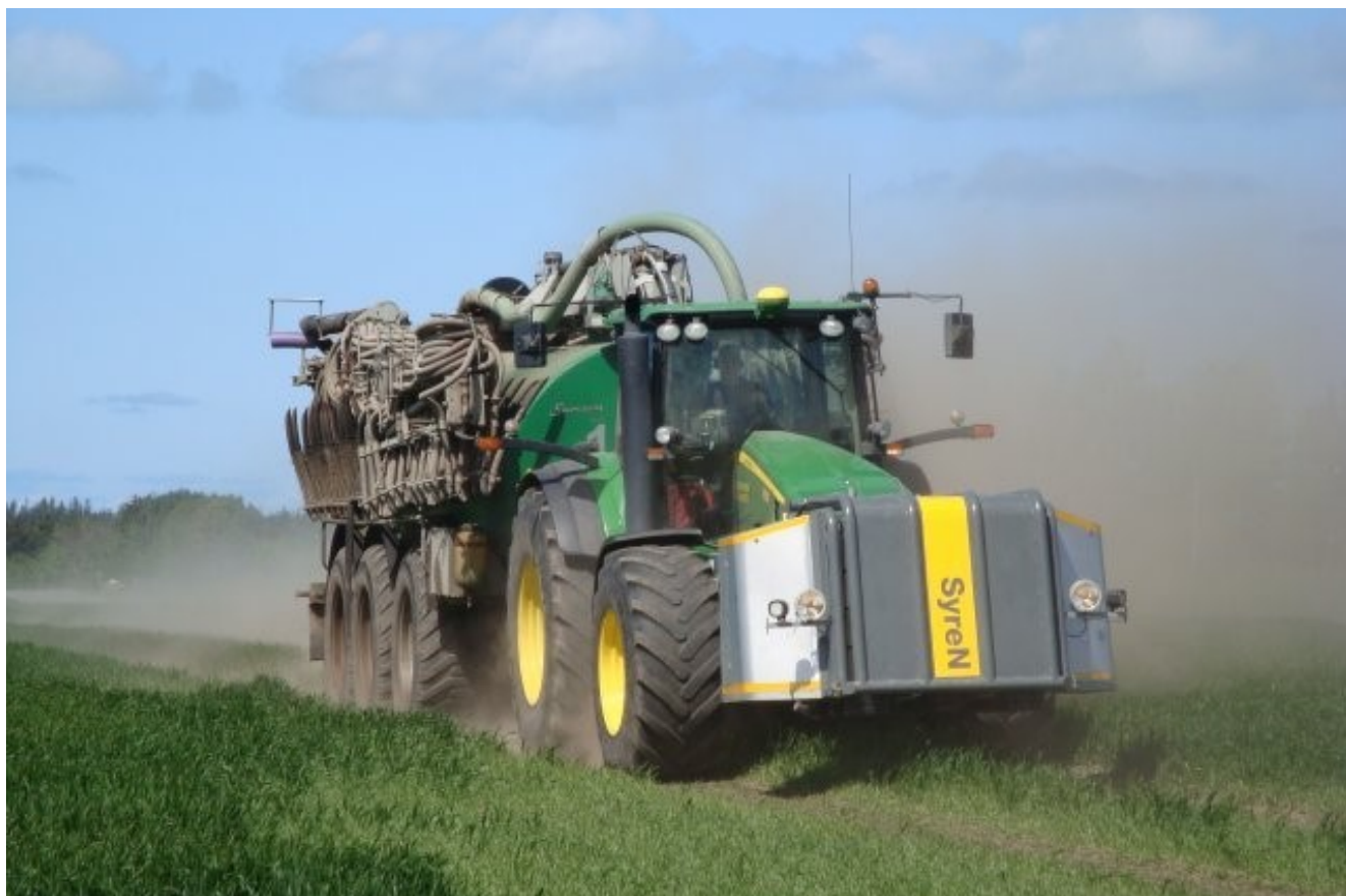
Forsuring af gylle ved udbringning på marken reducerer udslippet af klimagasser. Billedet viser BioCovers Syren-udstyr i brug.
