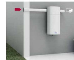
VBV: Brugsvandsvarmepumpe med indbygget varmtvandsbeholder. Opvarmer vandet ved hjælp af en varmepumpe, som trækker energi ud af udeluften. Er suppleret med el-patron til backup. Monteres på væggen i tekniskabet.
